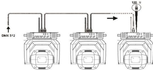
**注意：**请记住在最后一台灯具的信号输出连接一个回路插，此回路插在 CANON(卡依)插头的 2 脚和 3 脚之间连接了 1 个 120 欧的电阻，连接此回路插可有效地避免 DMX512 信号在传输过程中产生的信号反射现象。
