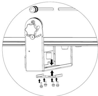
灯具安装在脚架时，脚架与灯具支架之间必须加上四颗螺丝固定，增加灯具的平稳性。
